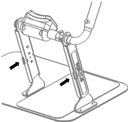
02 左右のボタンを押し込みながら、長さを調節します。
