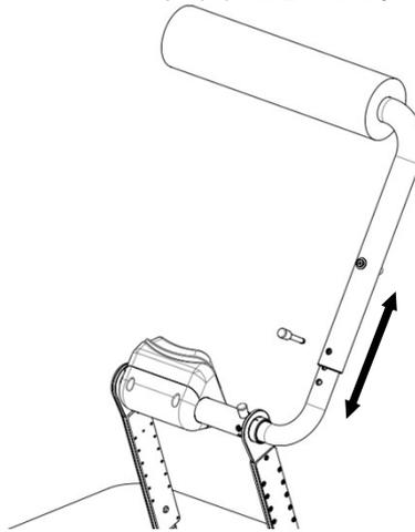
03 手順01で抜いたセットピンを差し込みます。
